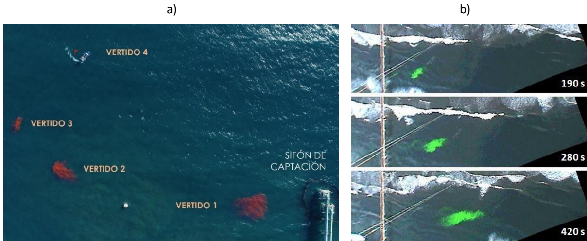
Figura 25: Vertido de a) rodamina vertida desde una embarcación y monitoreada con dron (Gentileza de Ecotecnos) y b) fluoresceína vertida desde un muelle y monitoreada desde un globo sonda (Takewaka et al., 2003).
