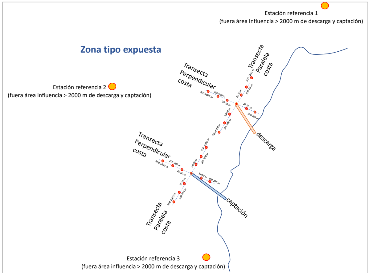
Figura 2: Esquema general de diseño espacial de estaciones de muestreo para Línea de base y Programa de Seguimiento, para 2 tipos de zonas de emplazamiento (zona tipo bahía y zona expuesta). Zona expuesta.
