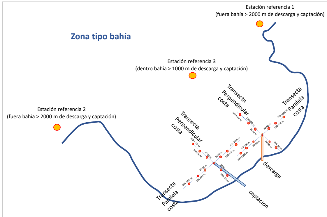
Figura 1: Esquema general de diseño espacial de estaciones de muestreo para Línea de base y Programa de Seguimiento, para 2 tipos de zonas de emplazamiento (zona tipo bahía y zona expuesta). Zona tipo bahía.
